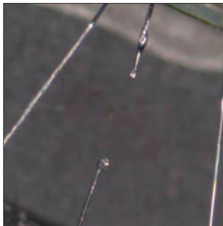
Рис. 1. Оплавление концов оборванной проволоки вследствие ESD или электрического перенапряжения
